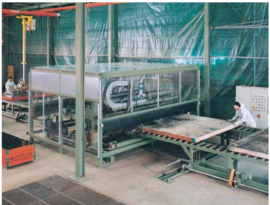
La instalación de limpieza de PERI en acción.
